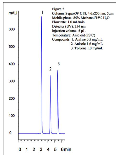
图 2: GP-C18 色谱柱 (4.6×250 mm) 质量控制测试色谱图
