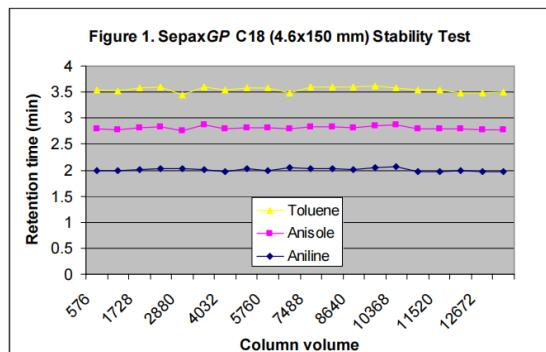
图 1: GP C18 柱 (4.6×150 mm) 稳定性试验
